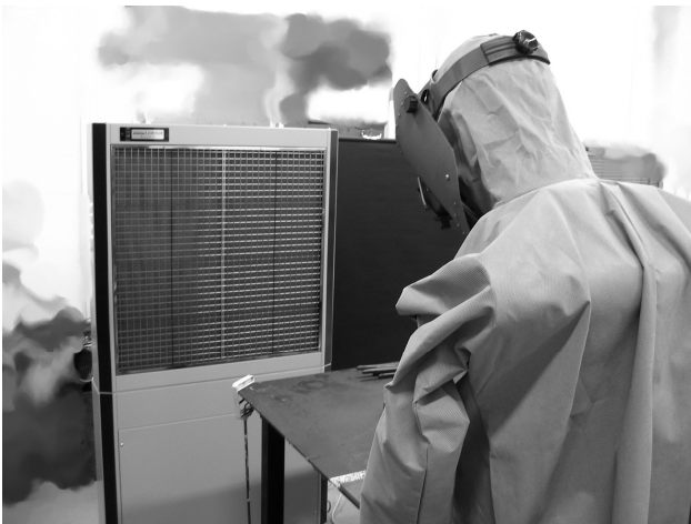
図 2 気流の存在が一酸化炭素の濃度測定に及ぼす影響を調べるための実験。気流はダミー作業員の正面から風速 0.3 m/s で吹き付けるものとした。
