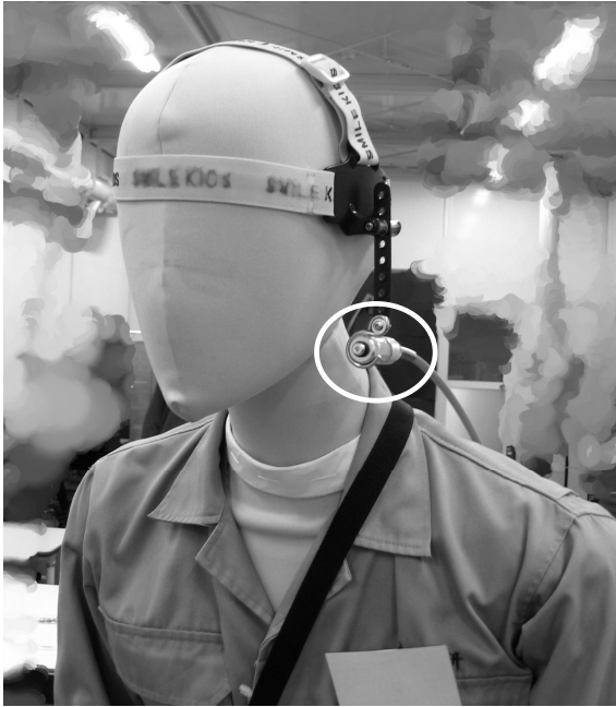
図 3-1 面体内部からのサンプリング方法の例
