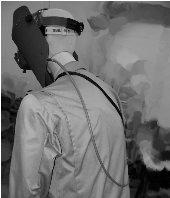
図 3-2 面体内部からのサンプリング方法の例
