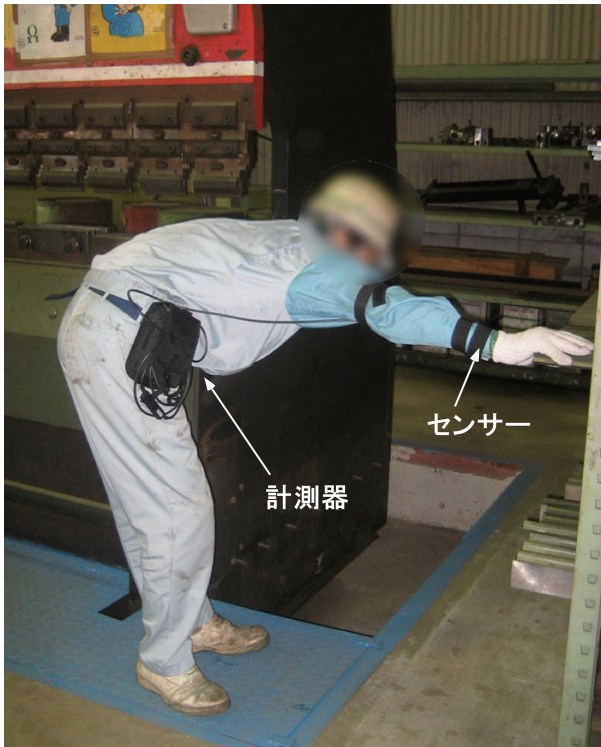
図 1 作業環境における磁界計測。磁界データは 3 軸磁界計測器を用いて取得した。磁界センサーは被験者の右手に装着した。
