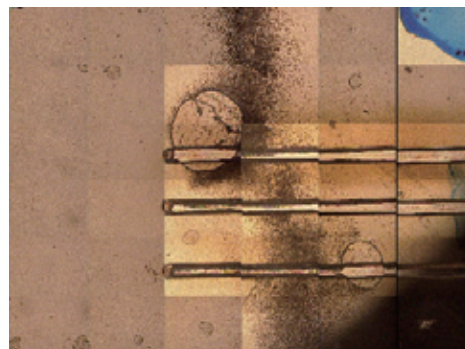
図7 樹脂による試料の固定例
