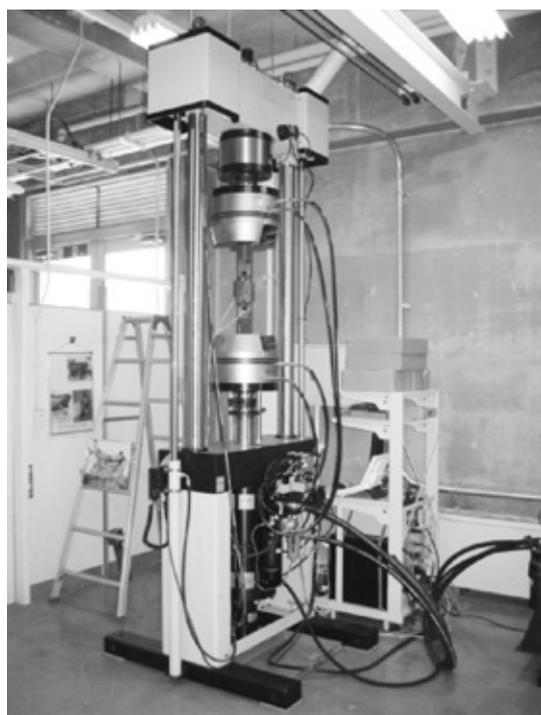
写真1 500kN容量電気サーボ油圧試験機
