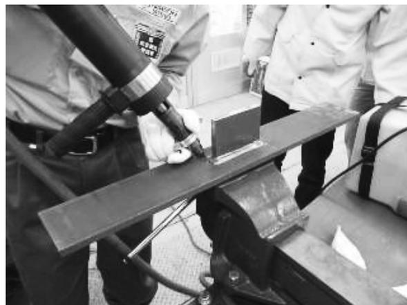
写真5 面外ガセット溶接継手のUIT処理
