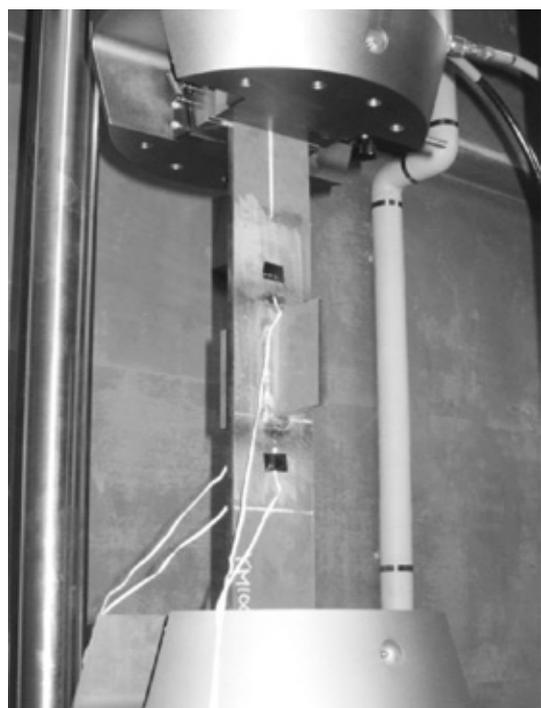
写真2 面外ガセット溶接試験体の取付状態
