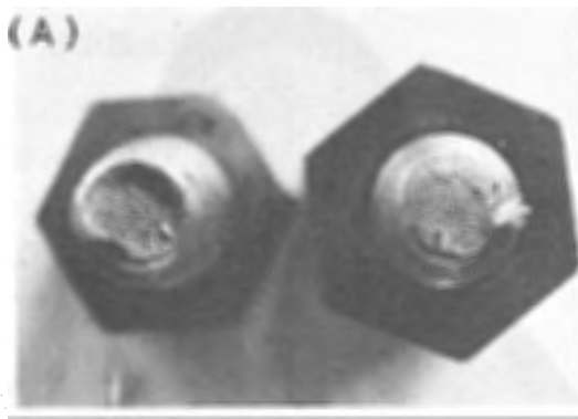
(A) Cup-and-cone type fracture. カップアンドコーン型破壊
