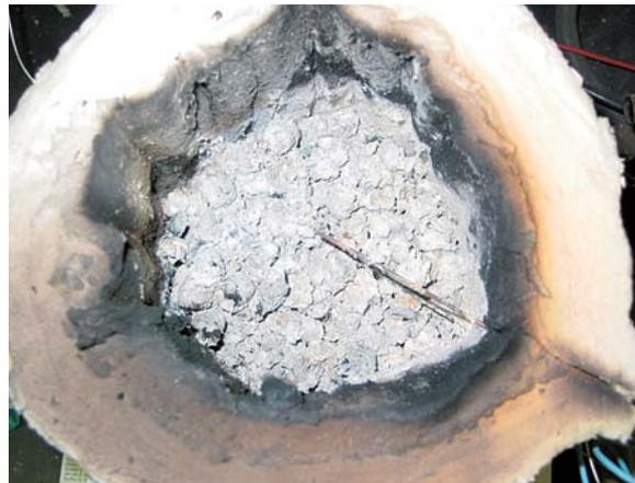
写真2-11 燃焼後のRDFの様子
