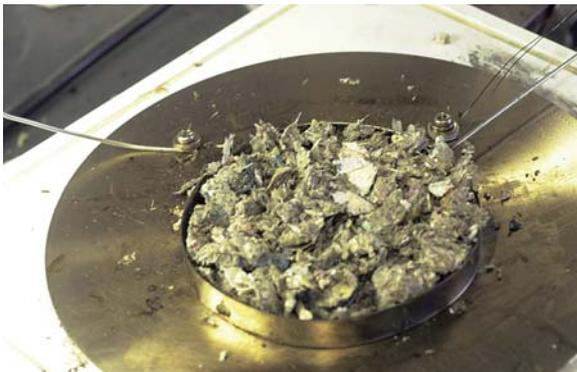
写真2-5 粗破碎したNo.3のRDF試料をホットプレート上に堆積させた様子（加熱前）
