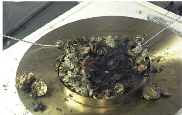
写真2-6 加熱実験終了後、層内をかき出した様子。
