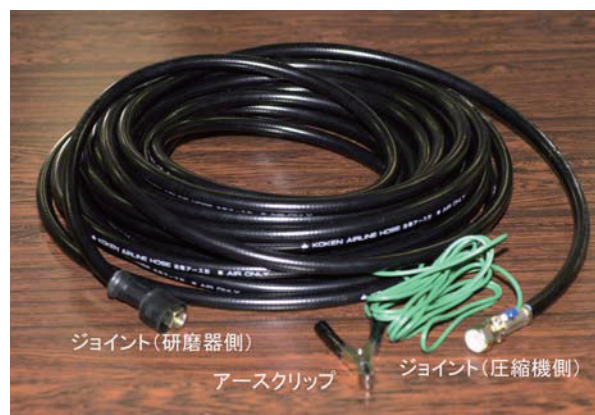
図15 導電性エアホースの例 (ジョイント間の抵抗が1 MW以下であること。接地線が不要なので、手持ち式研磨器に最適である。)
