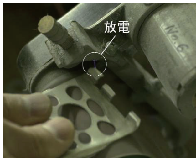
図10 研磨中に発生した静電スパーク (ローラとサンドベルトで発生した静電気が人体に蓄積し、およそ6kV以上となったとき、放電する。人体は約100pFのコンデンサとして機能している。)
