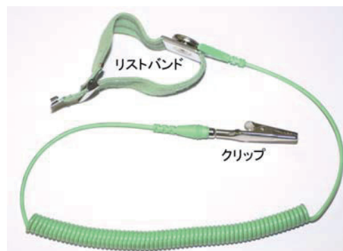
図17 帯電防止用リストストラップ (感電防止のため，必ず1MΩの抵抗入りのものを選択する。)
