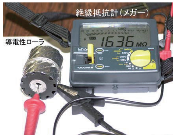
図13 導電性ローラの抵抗測定方法 （外周と軸間の抵抗を測定する。）
