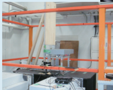
▲ 産業医学総合研究所に設置されている 6 軸加振器
