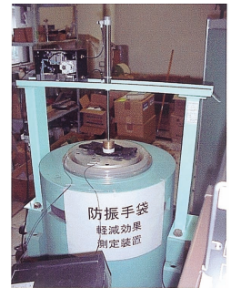
JIS T 8114に準拠した防振手袋の振動軽減効果測定装置
