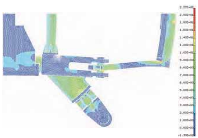
Fig. 7 Deformation and stress contour in the 2 nd trial. 二次案での変形拡大図および最大主応力コンター図
