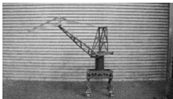
Photo. 3 Model for the shaking table tests 振動台実験用縮小モデル
