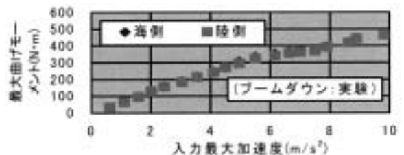
Fig. 6 Relation of input acceleration and maximum bending moment 入力加速度と曲げモーメントの関係
