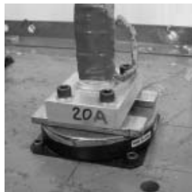
Fig. 4 Electromagnetic brake 電磁ブレーキ設置状況
