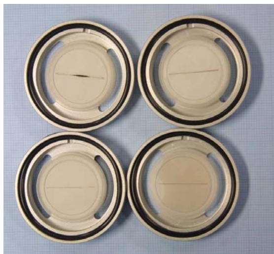
図 15 シュータスサンプラのサンプルングの状態
