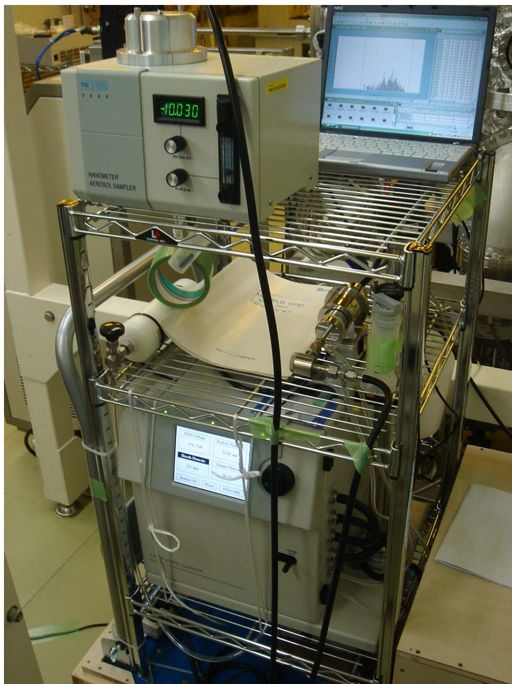
図 7 測定装置 上段手前は 静電気捕集器 奥は SMPS の制御 PC 中段は SMPS 用中和器 下段は SMPS 用 DMA
