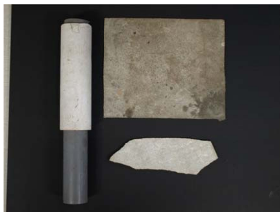
アスベスト含有建材(左：石綿二層管、右：スレート板)
