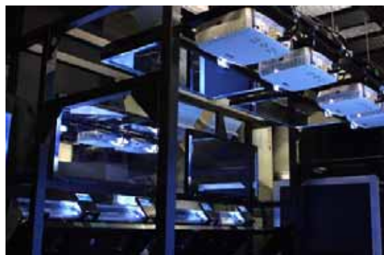
写真2 映像立体視化のためのプロジェクター
