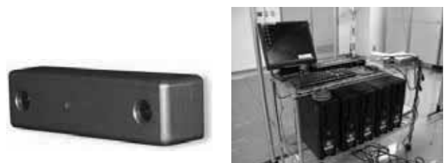
図3 立体視カメラ(左)と3次元空間情報統合システム(右)
