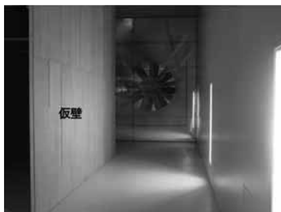
写真1 第2測定胴に設置した仮壁
