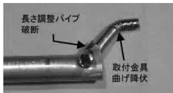
写真2 最終破壊状況例
