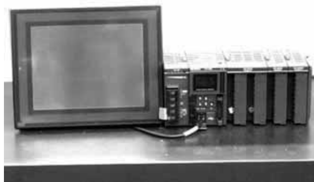
写真1 試作した引火点試験装置の制御部
