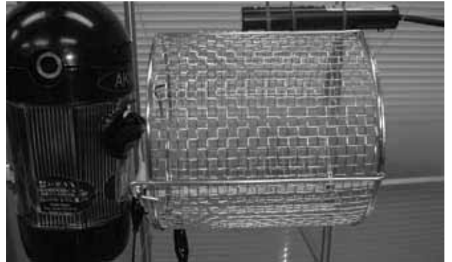
写真1 円筒ケージの電界計測による液滴の空間電荷密度測定
