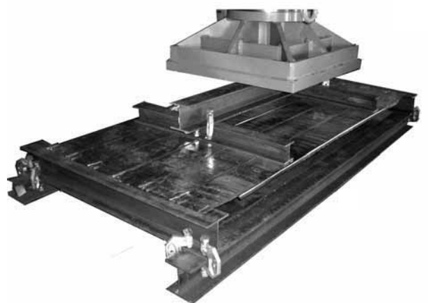
図2 曲げ強度試験の様子
