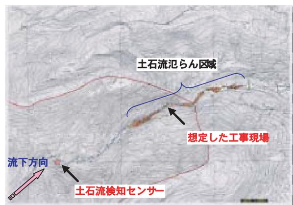
図3 2次元土石流氾濫解析の結果
