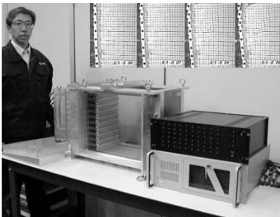
掘削時での地盤変形・崩壊現象の研究で用いる遠心模型実験用可動土留め
