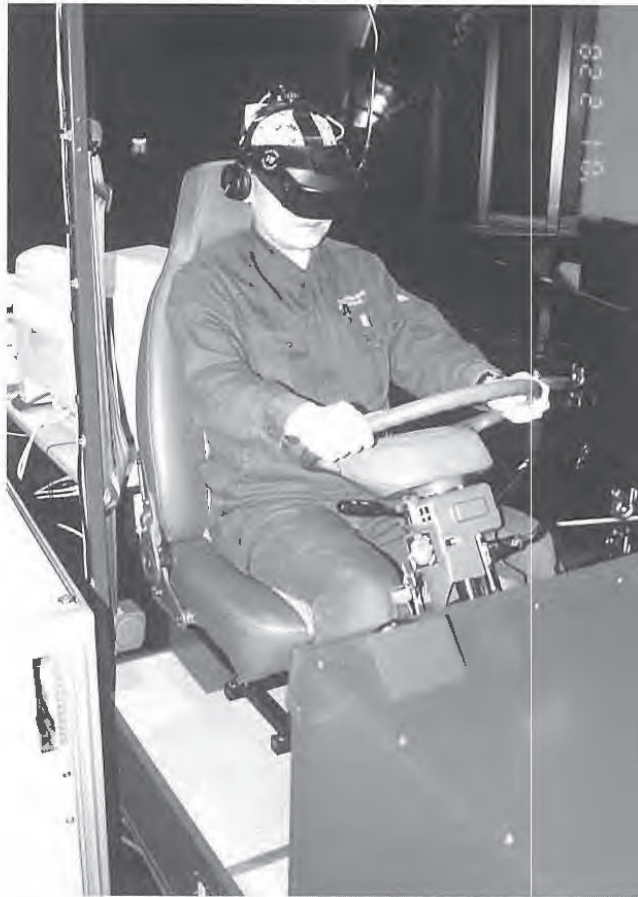
視覚情報処理過程とヒューマンエラーに関する研究に用いる運転行動測定装置
