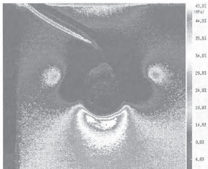
図2 ボルト摩擦接合継手の応力振幅分布 (ボルト軸力 F=16\text{kN} )
