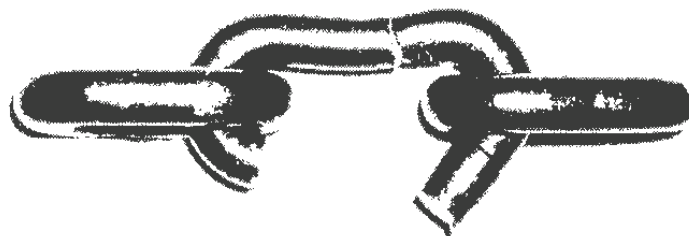
図3 疲労破壊したリンクチェーン (荷重振幅35.3kN)
