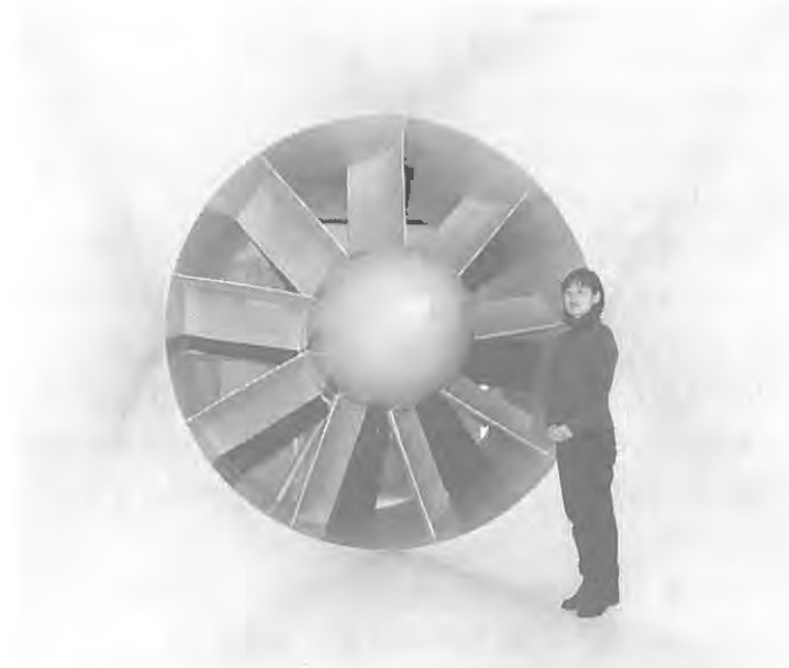
写真2 施工環境シミュレーターの送風機
