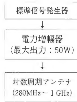
図1 無線周波電磁界放射部の基本構成
