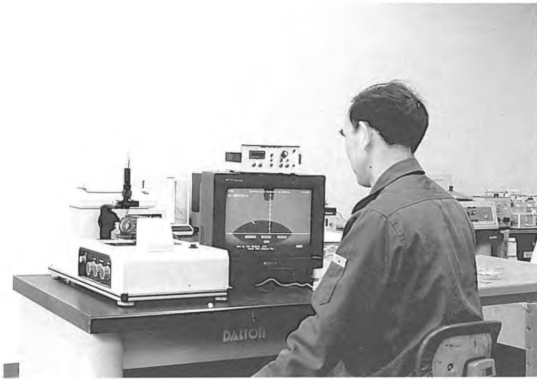
絶縁材料の特性劣化の研究に用いる接触角測定装置
