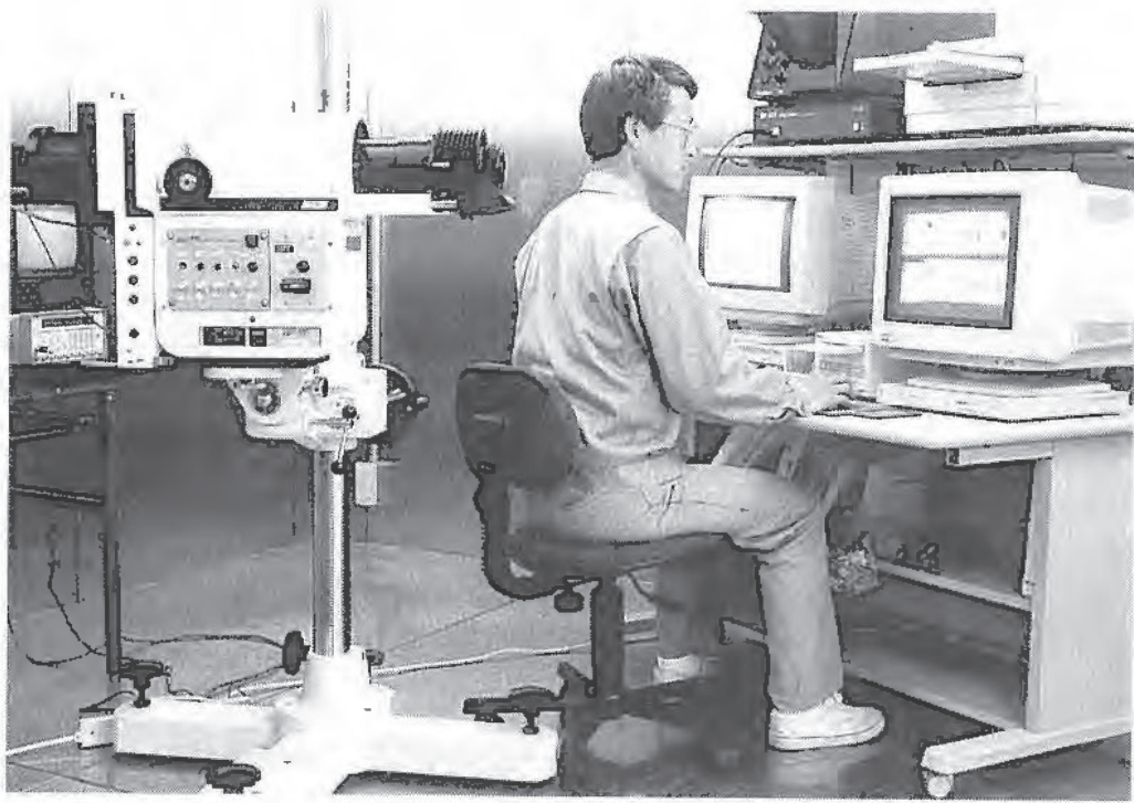
静電気放電特性などの高速現象の解明に用いる イメージコンバータカメラ
