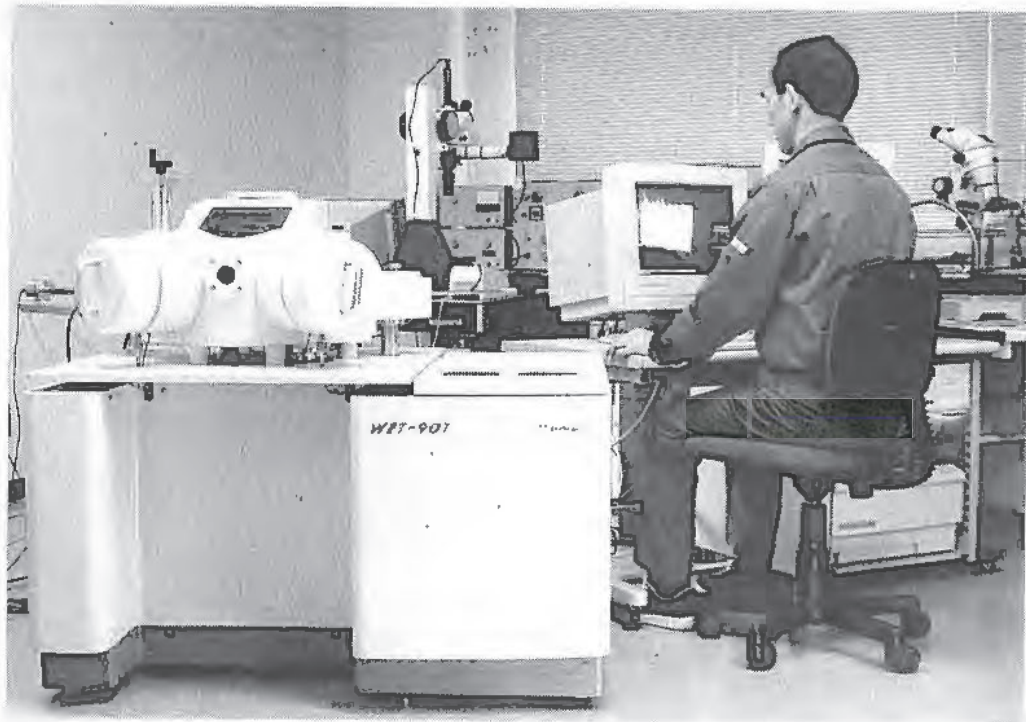
電気絶縁材料の表面劣化特性の解析などに 使用するトンネル顕微鏡
