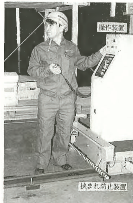
図17 安全作業システムと挟まれ防止装置
