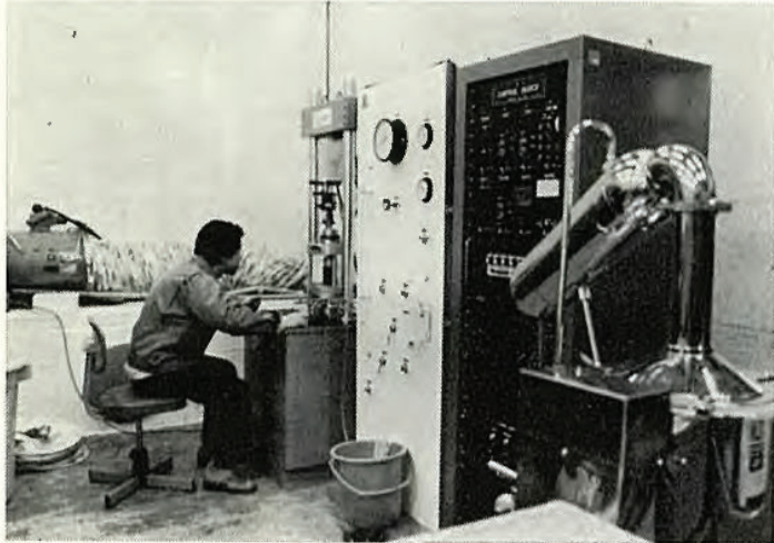
振動三軸圧縮試験機による土の強度測定
