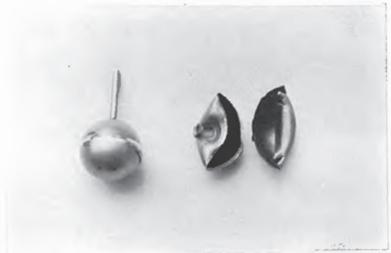
反応性物質による試料容器の破壊状況
