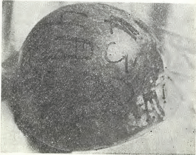
写真11 石油化学工場で5年8ヵ月使用したポリカーボネート帽体。帽体の頂部は溶剤がかかったので歪み模様がで、かつ侵食された部分は0.1~0.5mm 帽体の肉厚が薄くなっている。
