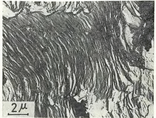
写真6 プレス安全装置セットボルトの電顕像
