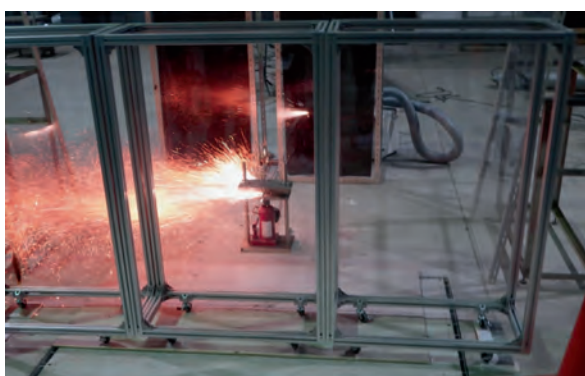
3) リチウムイオン電池の圧壊による発火実験
