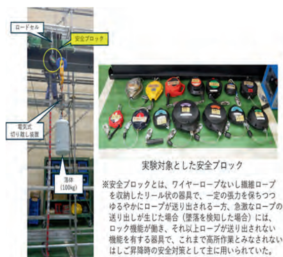
図3 安全ブロックと実験時写真
