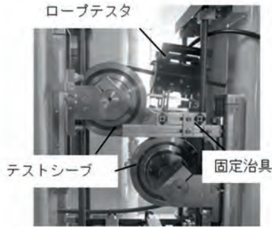
図 7 ワイヤロープテスタ測定の様子
