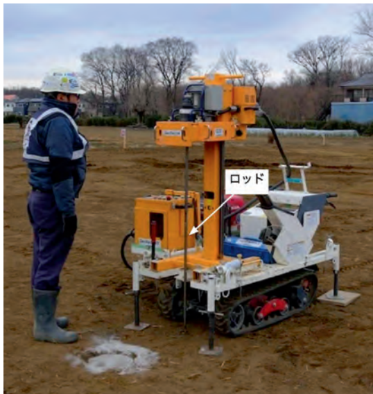
図 2 スクリューウエイト貫入試験(SWS)の概要
