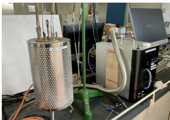
図 1 調査に用いたグレーバ炉の外観
