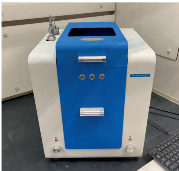
図4 実験に使用した小型反応熱量計の外観
