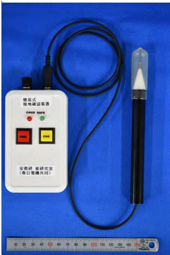
図8 ハンディータイプ接地確認装置(簡易式)
