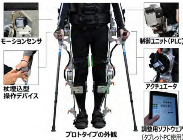
図 3 脊椎損傷者用歩行支援機器のプロトタイプ
