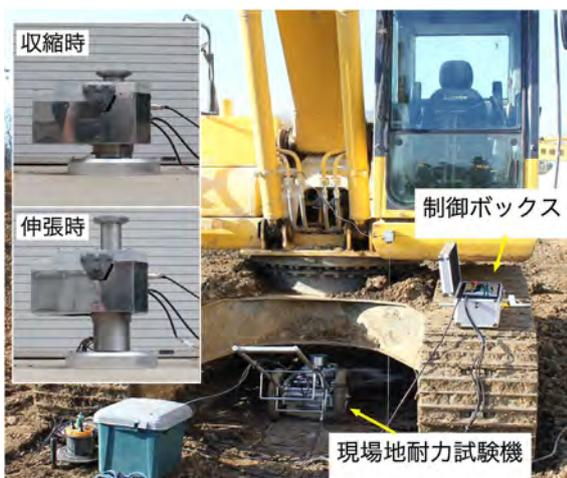
図1 現場地耐力試験(BCT)の概要
