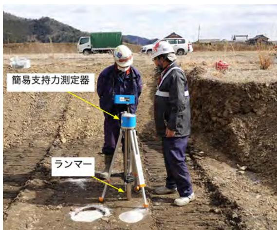
図2 簡易支持力測定器(CAS)の概要
