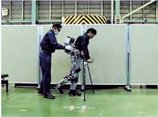
脊椎損傷者用歩行支援機器の試作と評価
