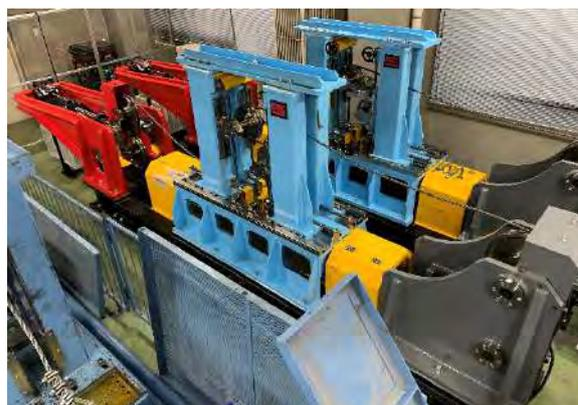
図 2 往復駆動型ワイヤロープ試験機(1, 2 号機)
