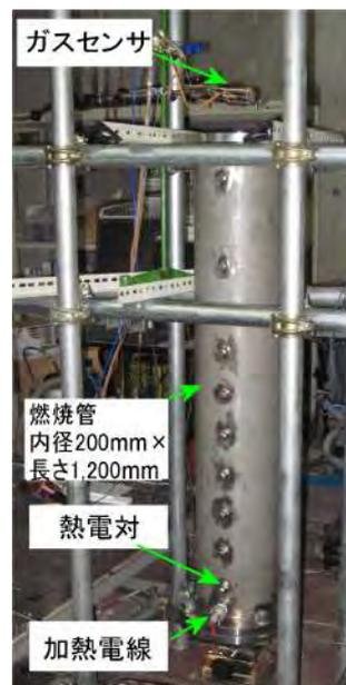
図 2 燃焼管を使った実験の様子
