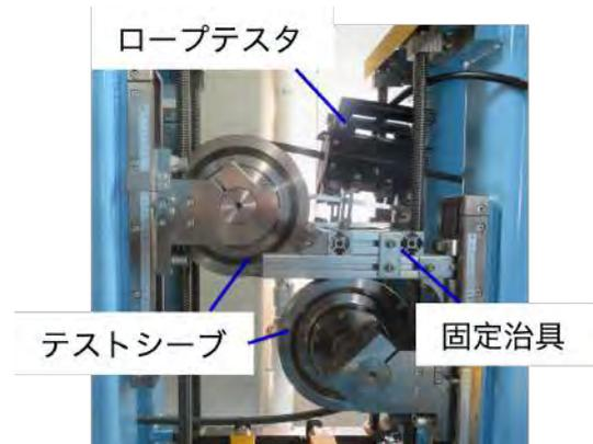
図4 ワイヤロープテスト測定用の試験環境
