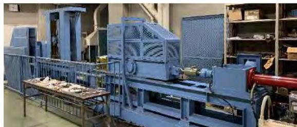
図 1 回転駆動型ワイヤロープ試験機(0 号機)
