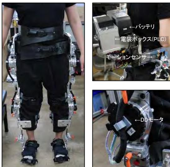
図2 プロトタイプの外観
