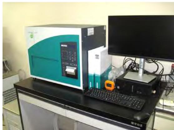
図 1 定常法熱伝導率測定装置の外観
