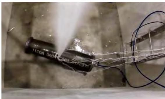
材料の減肉による破裂現象試験
