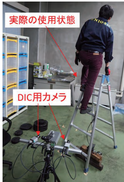
図 9 脚立を使用した状態における DIC の測定
