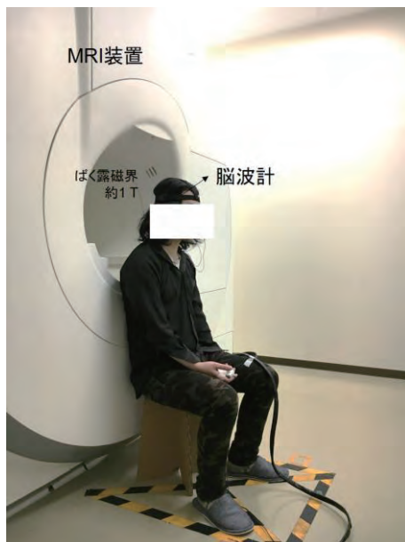
図7 高磁界中での脳波測定の様子。
