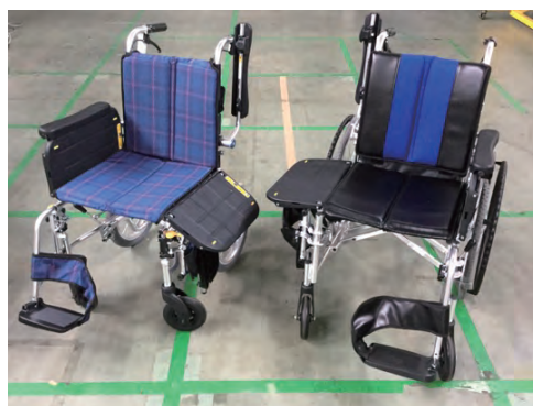
図5 トランスファボード付き車椅子2機種 (左が介助式、右が自走式)
