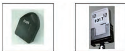
図 15 UWB アクティブ RFID タグと UWB 固定機
