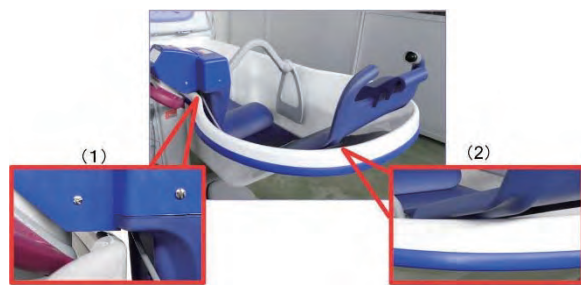
図 2 検証対象の機器および危険部位
