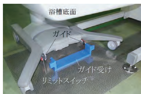
図 3 位置決めガイド機構の実装
