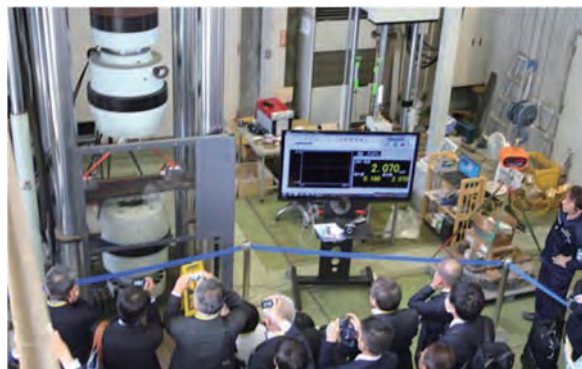
ベルトスリングの破断実験(吊り角度の影響)
