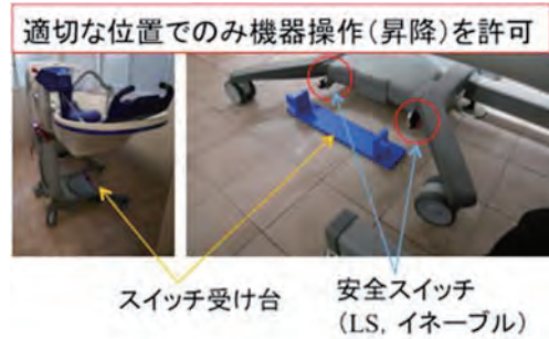
図2 インタロック機構の実装
