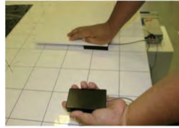
図4 人体通信装置の検証
