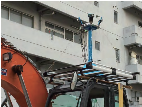
写真1 開発した動態検知センサシステム
