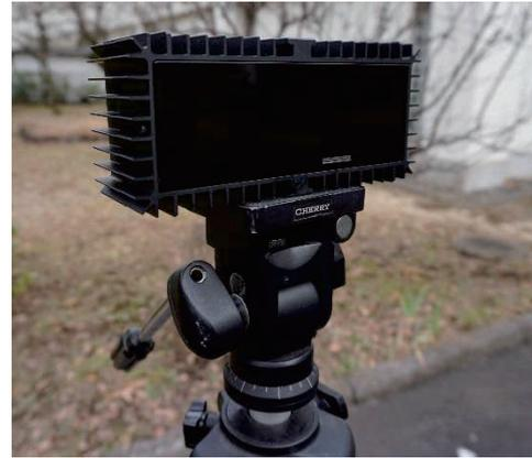
写真1 実験で使用した3次元距離画像カメラ
