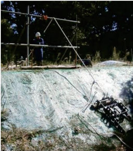
図9 親網固定支持点の衝撃載荷試験
