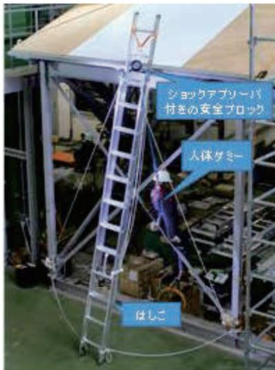
図6 墜落実験後の人体ダミー等の様子
