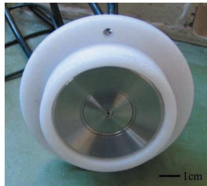
図4 振動型静電界センサ
