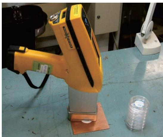
図4 銅板上にチタン既知量のフィルター試料をのせて作成したHHXRF測定の検量線
