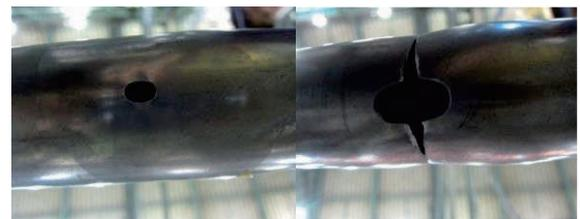
a.孔食穴径5mm      b.孔食穴径10mm
