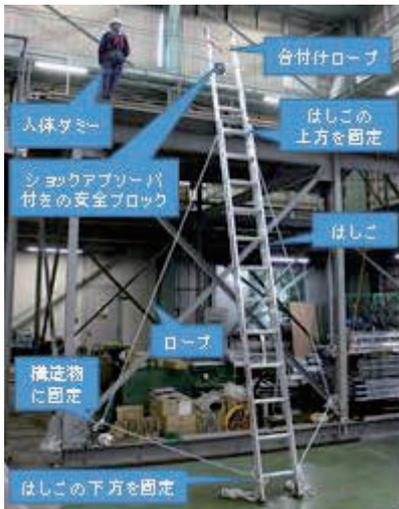
図5 移動はしごを用いた墜落防止対策の工法
