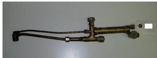
(c) ガス溶断器(吹管)
