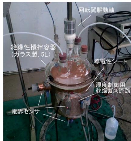
図1 卓上型攪拌帯電実験装置
