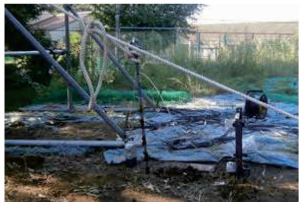
図13 完全に引き抜けたアンカー (根入れ0.5m)
