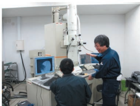
透過型電子顕微鏡での試料観察
