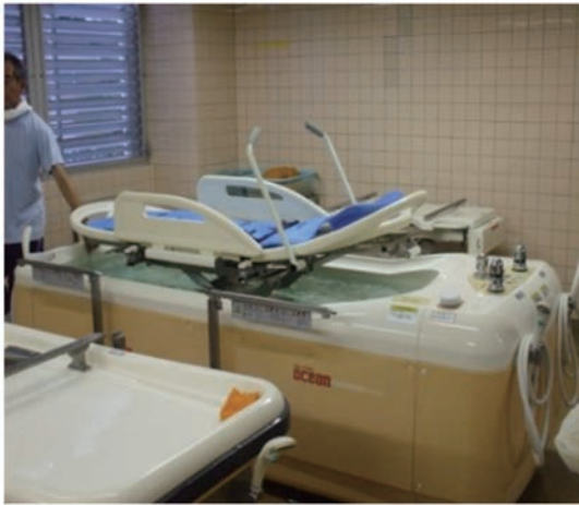
図2 ロボットアーム式(上)とストレッチャー式(下)の特殊浴槽
