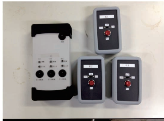
写真1 建設機械用遠隔非常停止装置
