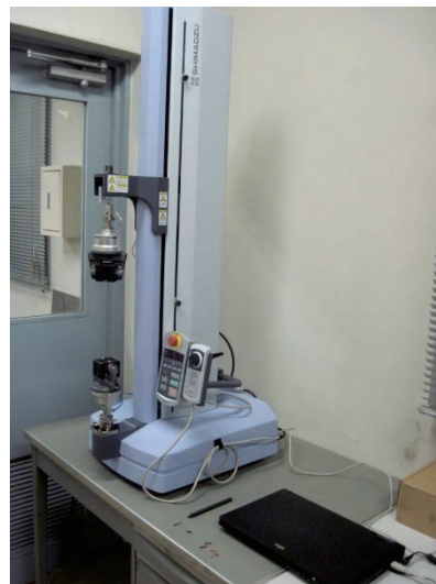
図6 ゴム用小型卓上型引張試験装置
