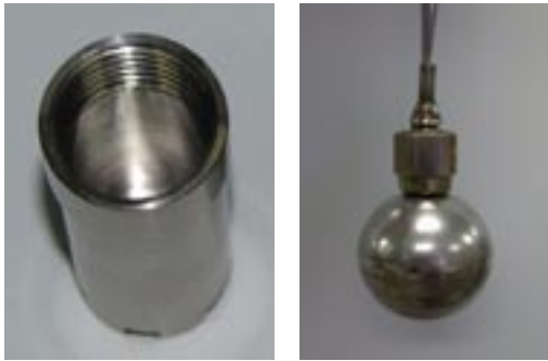
高性能型 (dARC) 従来型 (ARC) 図 7 熱分析装置の容器
