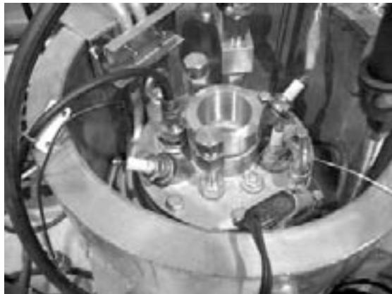
図 8 改良型引火点試験装置
