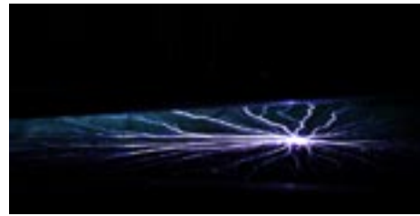
図4 ポリエチレンフィルムで発生した沿面放電
