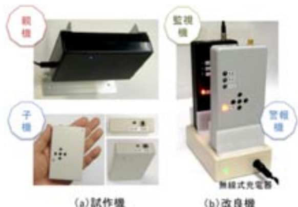
図2 開発した無線式安全運転支援装置
