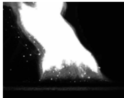
図6 水で湿ったマグネシウム粉の燃焼
