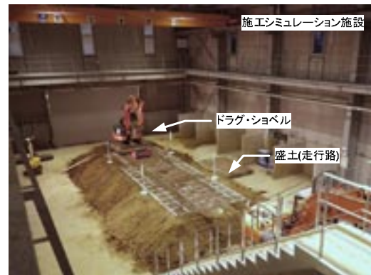
図6 現場地盤を模擬した走行路の様子
