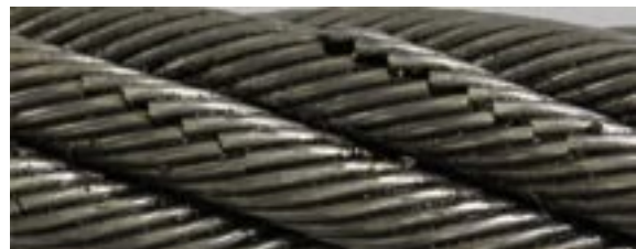
写真1 IWRC6×WS(31)の素線断線例(Crown断線)
