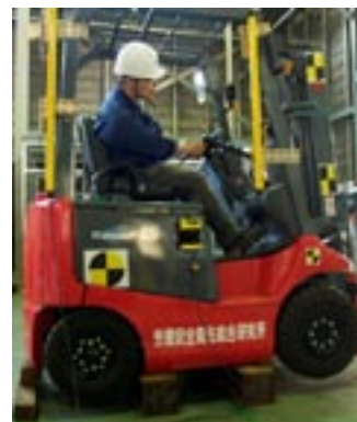
図3 運転者保護装置の動作確認実験
