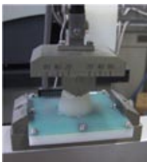
図1 開発した衝撃力計測装置
