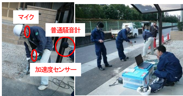
図2 ハンマードリルによる研り(はつり)作業での測定
