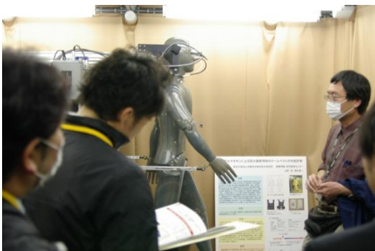
写真1 サーマルマネキンや温熱生理実験による暑熱負担の測定と評価
