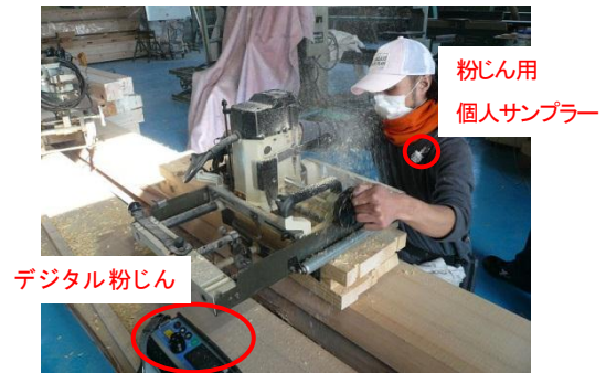
図3 大入りルータによる木材の切削作業の測定
