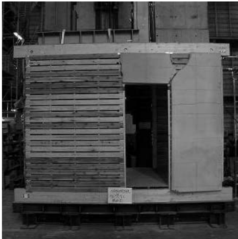
写真5 損傷を受けた木造建築物モデル
