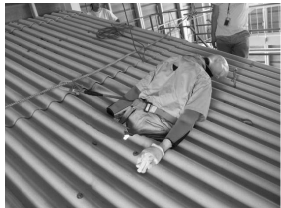
写真6 人体ダミーを用いた踏み抜き落下試験状況
