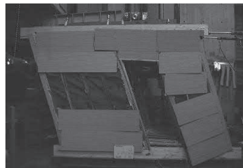
写真5 外壁がサイディング試験体の最終破壊状況
