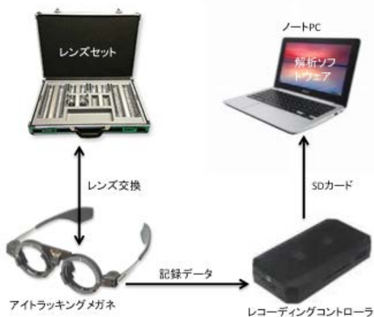
図1 レンズ交換式メガネ型アイトラッキングシステムの基本構成
