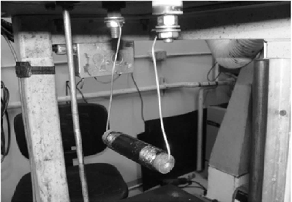
図 18.8.2 : 圧力容器のカバーの下に水平に設置された試験セル (容器の固定電極に接続された銅伝導体)
