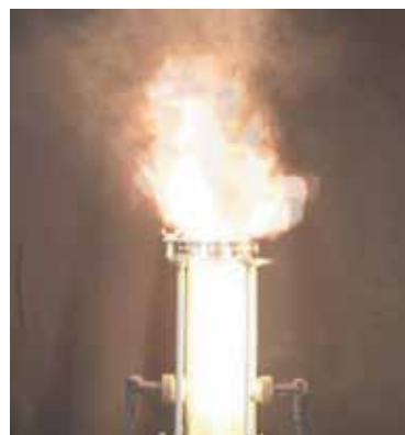
石松子粉の爆発性試験 Flammability test of lycopodium dust.
