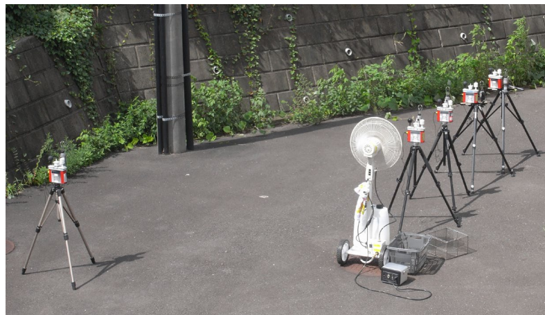
ミストファンによる暑熱軽減の検討実験
