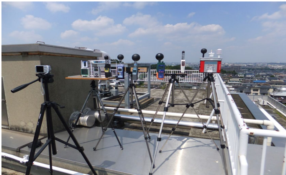
様々なWBGT測定器の併行測定による測定精度の検証実験
