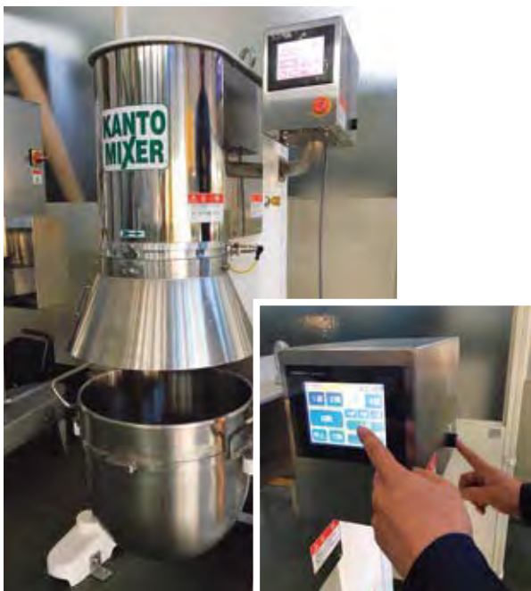
写真1 両手操作方式を導入したミキサー
