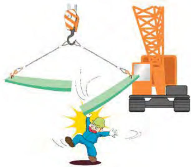
図3 吊り荷の破壊が引き起こす災害例
