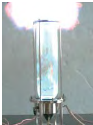
写真1 可燃性蒸気の爆発実験
