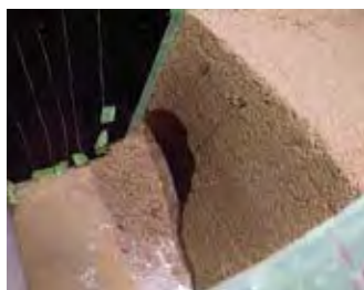
水を使った斜面崩壊実験
