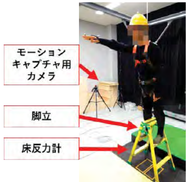
写真2 作業者のバランス評価実験の様子
