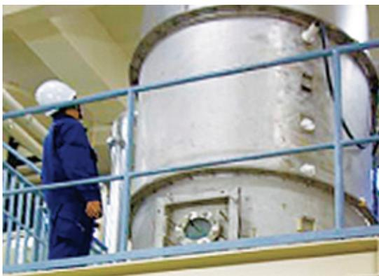
写真1 実規模粉体空気輸送実験装置
