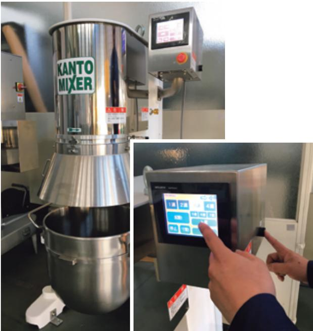
写真1 両手操作方式を導入したミキサー
