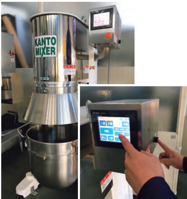
写真1 両手操作方式を導入したミキサー
