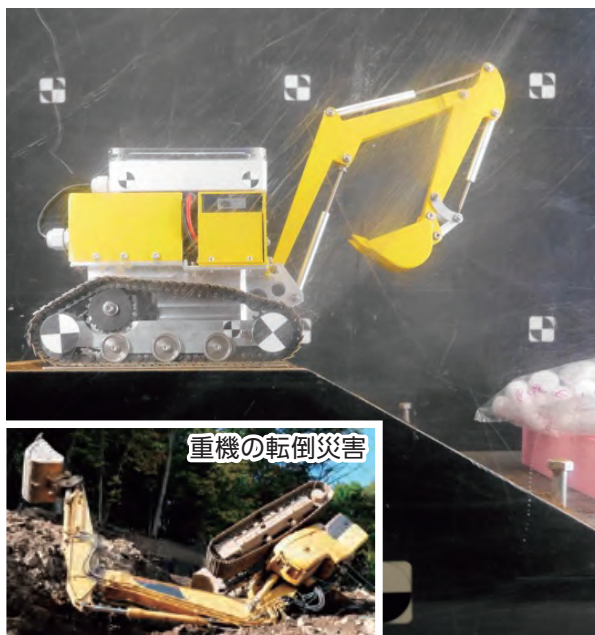
写真1 ドラグ・ショベル模型による実験
