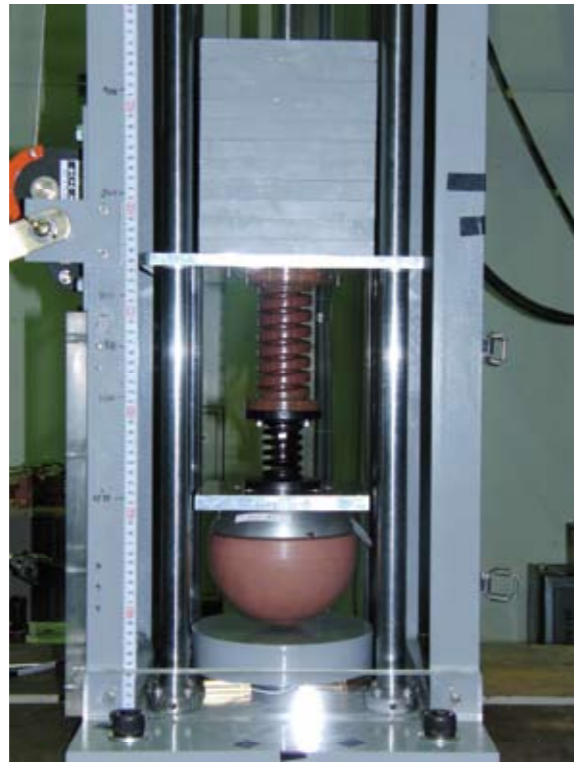
人体頭頸部モデルによる落下試験の様子
