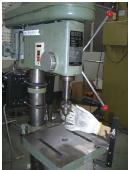
ボール盤による巻き込まれ災害体感装置
