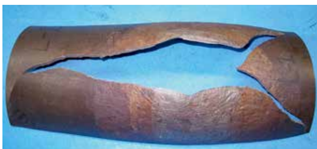
減肉鋼製配管の破裂試験
