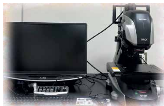
皮膚観察用デジタルマイクロSCOPE Digital microscope for Dermal observation
