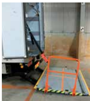
着脱式のテールゲートリフター転落防止柵の開発 Development of a fall preventive detachable railing from tailgate lifter (tail lift) platforms.
