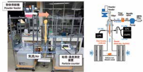
落下法による、粉体取り扱い作業時に発生する粉じんの模擬発生システム Dust generation system simulated for powder handling processes by a drop method.
