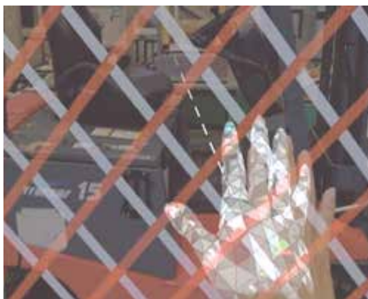
MR（複合現実）技術によるフォークリフトへの人の接近情報の提示 Alert indication for approaching person(s) to forklift using MR
