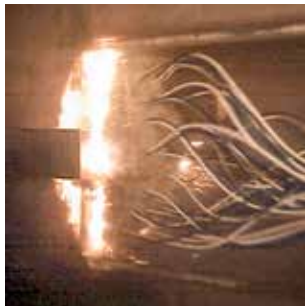
トンネル切羽における発破掘削模擬実験 Blasting test at tunnel cutting face of model ground.
