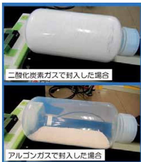
ガスによる静電気低減の研究 Reduction of static electricity in argon ambience.
