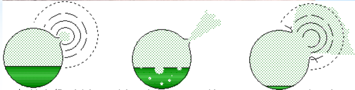
BLEVE(沸騰液膨張蒸気爆発)→
