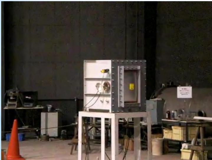
爆発圧力放散口実験 (メタン-空気当量比1 200L)
